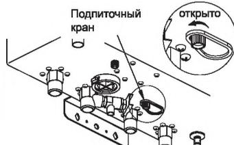
4.2. Когда показания стрелки манометра окажется в пределах 1,2-1,5 бар, закройте подпиточный кран.
