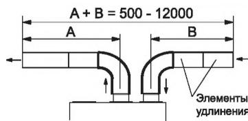
При монтаже раздельной системы дымоудаления, труба отвода дымовых газов всегда присоединяется к центральному патрубку, а труба для забора воздуха присоединяется к правому или левому патрубку, в зависимости от удобства монтажа. Незадействованное воздухозаборное отверстие закрывается специальной заглушкой.
