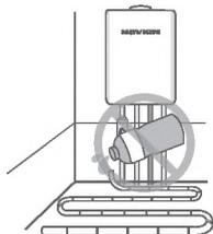
3. Котлы Navien Deluxe S оснащены встроенными сетчатыми фильтрами отопительной воды. На обратном трубопроводе системы отопления, перед котлом, рекомендуется установить дополнительный косой сетчатый фильтр, для очистки отопительной воды от нежелательных примесей.
