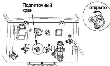
4.2. Когда показания стрелки манометра окажется в пределах 1,2-2 бар, закройте подпиточный кран.
